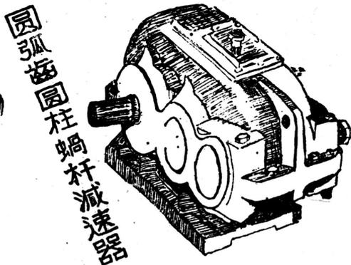
圆弧圆柱蜗杆减速机
