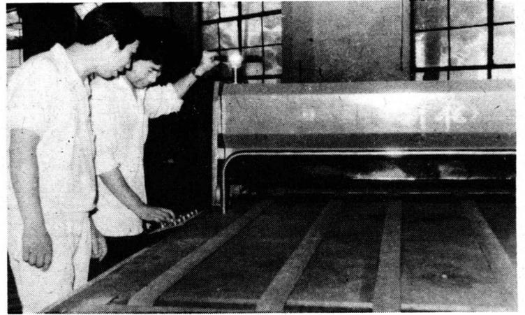
一种国内先进的纸箱生产设备——自动平台辗压模切机,最近在西安新飞包装设备厂问世。该机具有效率高、安全方便等特点,造价仅为同类进口设备的一半。
