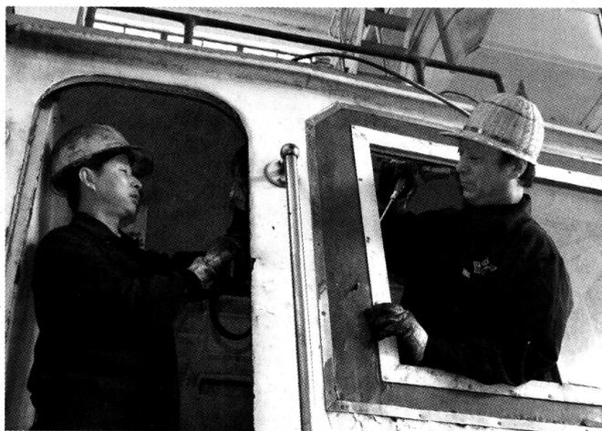
**新丰镇机务段** 全面做好内电机车冬整备工作,狠抓机车取暖设施、空气、油路管路等关键部位的普查整修,以确保冬季行车安全。图为10月16日该段检修职工正在整修机车门窗缝隙。郭志明 摄
