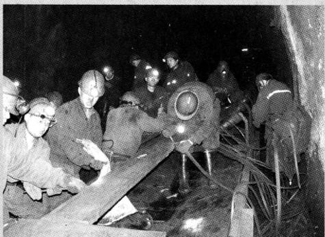
近日,象山矿井主暗斜运输大皮带出现鼓包现象,给安全生产带来严重隐患,并造成井下原煤运输系统的瘫痪。该矿立即组织人员,制定相应措施,积极进行抢修。机运队干部和职工在其他单位的协助下,齐心协力在井下加班加点连续作战,在最短的时间内更换30米常有故障的运输皮带,确保了原煤运输的畅通。图为该矿职工正在抢修运输大皮带。田有志 摄
