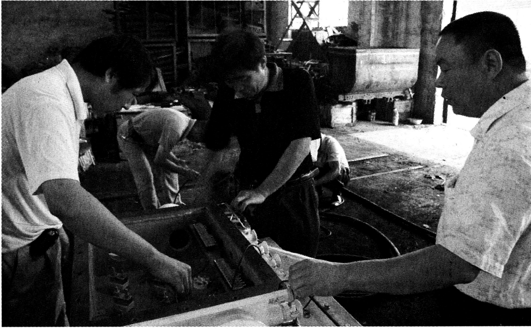
象山矿井机械科千群加班加点,为即将投入井下运行,由太原惠特科技有限公司生产的QJR-400/1140矿用隔爆兼本质安全型交流真空软
