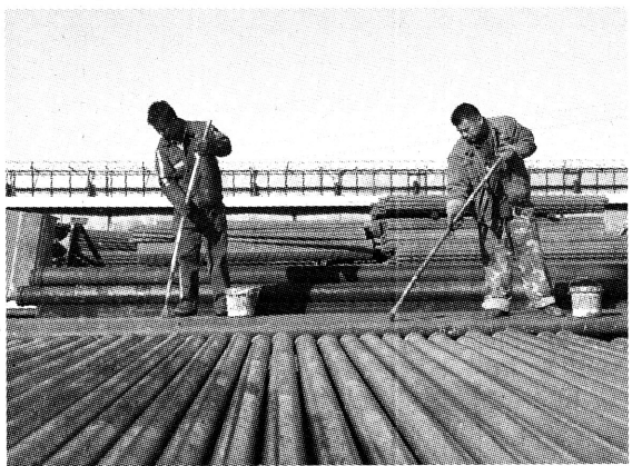
韩家湾煤炭公司把矿井各种设备材料的回收、维修、复用作为应对市场变化、促进节支降耗的主要手段, 从而为公司节约了资金, 创造了经济效益。图为维修人员正在对井下回收上来的管材进行除锈、刷漆处理。 王玉 魏小波 摄
