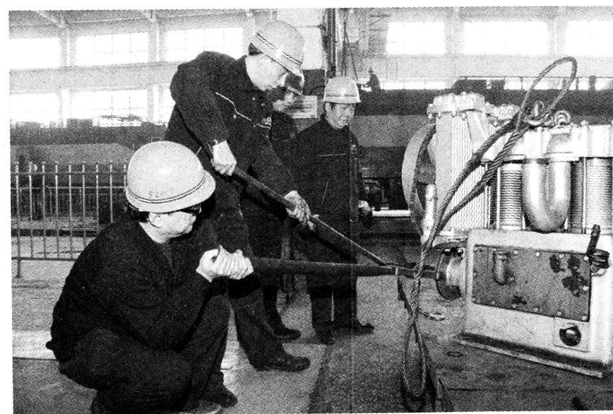
连日来,西安机务段党委深入开展以“保安全、保质量、保畅通、无事故”为主题的立功竞赛活动,充分发挥一线党员业务骨干的模范带头作用,努力确保节后春运返程客流高峰安全畅通。 图为党员业务骨干正在对机车空气压缩机进行精检细修,确保机车制动系统性能可靠。 刘翔摄
