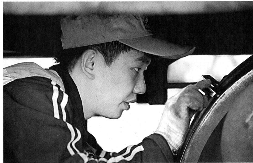
近日,西安东车辆段举办了运用、站修系统的5个工种77名选手参加了比武竞赛。图为这个段列检青工高飞正在检查确认TPDS预报车轮故障。胡小文 摄
