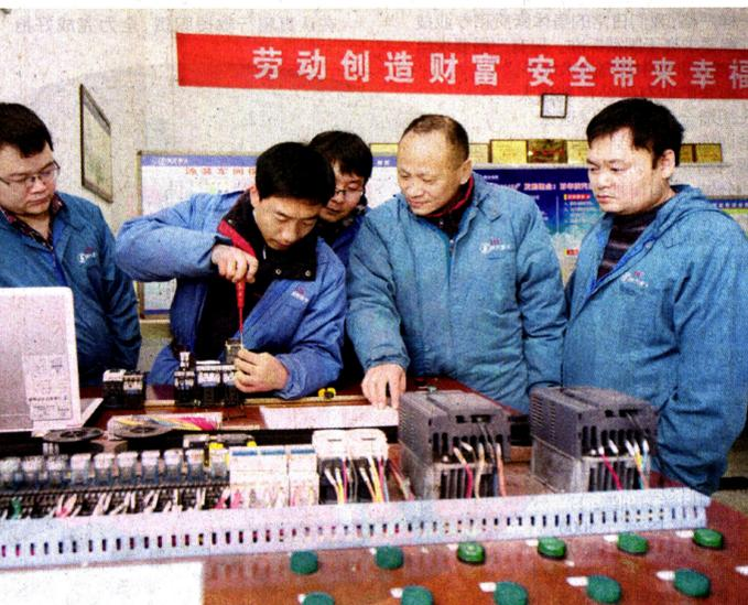
陕汽集团电工技师李青刚制作的电工模拟现场培训平台,提升了维修技能水平和维修电工的故障排除反应速度,为陕汽重卡产能提升奠定了基础。图为近日,职工在该平台操作。 谭永平 摄
