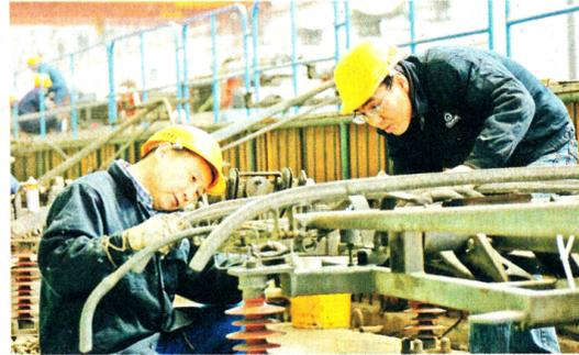
近期,宝鸡机车检修厂组织技术骨干对机车走行部、车顶高压设备等关键部件进行逐项检查,摸清设备技术状态,有针对性地开展设备隐患排查整治,促进设备质量达标。图为3月22日,该厂检修车间职工正在检查机车受电弓技术状态。赵选田 摄
