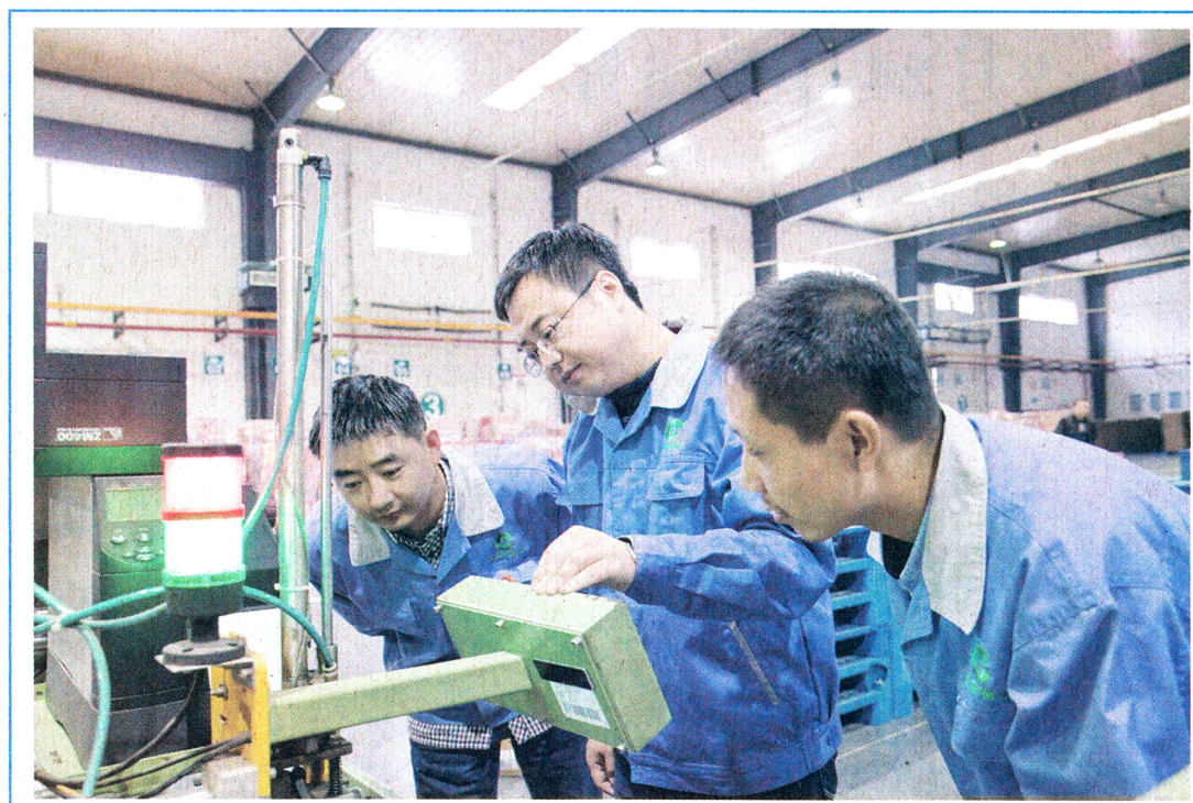
自去年以来,针对卷烟自动贴标机运行过程中故障率高的问题,咸阳烟草物流分公司储运部副部长张勇作为QC小组活动带头人,带领组员开展了以《降低卷烟自动贴标机故障率》为课题的小组活动,对卷烟自动贴标机贴标装置的结构进行了优化和改进,有效杜绝了贴标装置上吸嘴的损坏。图为12月13日,张勇(中)与分抹员雷旭刚(左)、设备维修员杜金全(右)正在查验改进后的设备。
