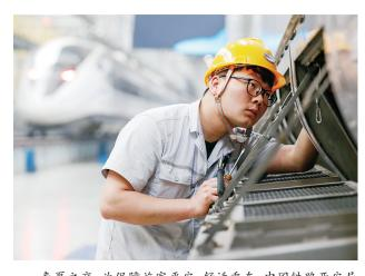
春夏之交,为保障旅客平安、舒适乘车,中国铁路西安局 集团有限公司西安动车段扎实开展防暑整备工作,盯紧车厢 空调组件、车内排水系统以及各部通风散热装置的检查及清 洁作业,严格卡控作业质量,高标推进整备任务。图为西安 动车段团员青年正在检查、清洁车侧滤网。 □ 吴瑞西 摄
