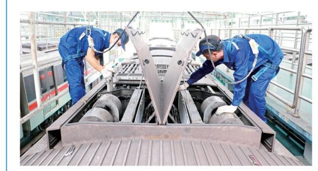
为了给出行的市民、游客提供舒适、凉爽的地铁服务,车辆检修人员高温下坚守岗位,辛勤作业。图为西安地铁渭河车辆段车辆检修二车间的员工对列车空调机组内部开盖检查,对滤网进行更换。 甘达 摄
