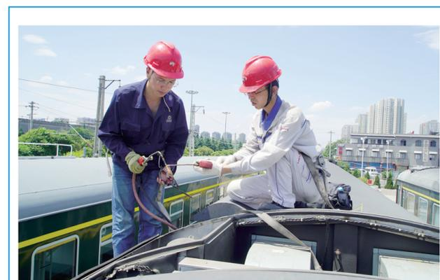
虽已立秋,但陕西地区高温天气依然持续。为了给暑期出行旅客营造舒适凉爽的乘车环境,中国铁路西安局集团公司西安客车站段组织技术力量全面整治客车空调故障,保证各次列车空调“零故障”运行。图为8月7日,该段空调检修人员正在库内列车车顶处理空调制冷剂泄漏故障。 赵伯顺 摄
