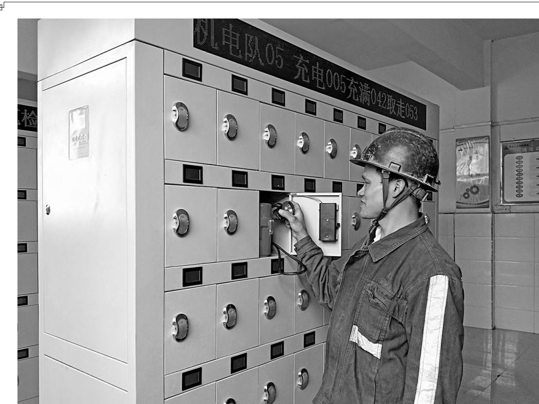
8月28日，黄陵矿业瑞能煤业机电队为充电房更换了新的智能型数显矿灯充电架系统，为该矿实现矿灯存取、充电信息自动统计以及职工出入井考勤等全过程动态管理提供了方便。
