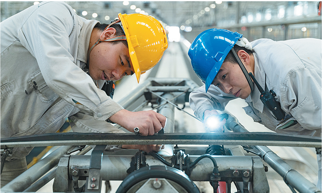
近日,中国铁路西安局集团有限公司西安动车段结合往年动车组冬季运行交路特点,提前编制检修计划,组织检修人员对配属动车组开展“秋季整修”“防寒整修”。图为动车组质检员检查受电弓碳滑板厚度。 张文 摄
