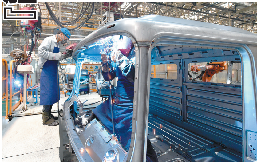
7月1日，工人在陕西重卡汽车有限公司驾驶室总成装焊线上作业。袁景智 摄
