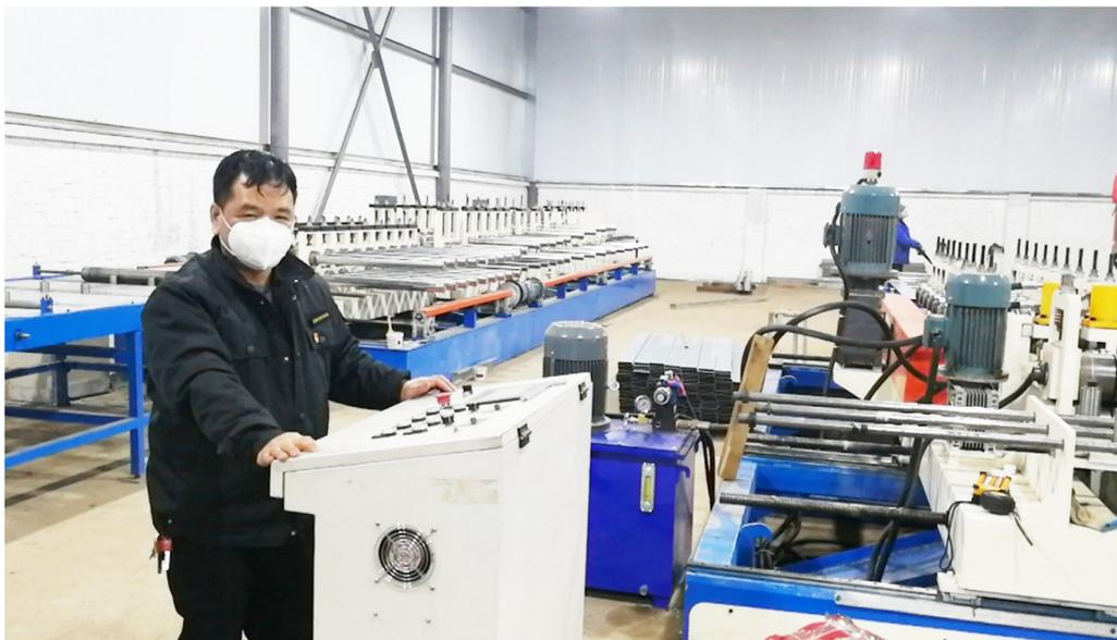
近日,陕建安集团所属陕西西桥电气有限公司接到采购订单,为某项目紧急生产热镀锌电缆桥架5682米,弯通289套,并在2日内供货到场。该公司紧急安排复工复产,奋力抢抓生产任务。图为工人正在车间加紧生产。 □张筠 王诗萌 摄
